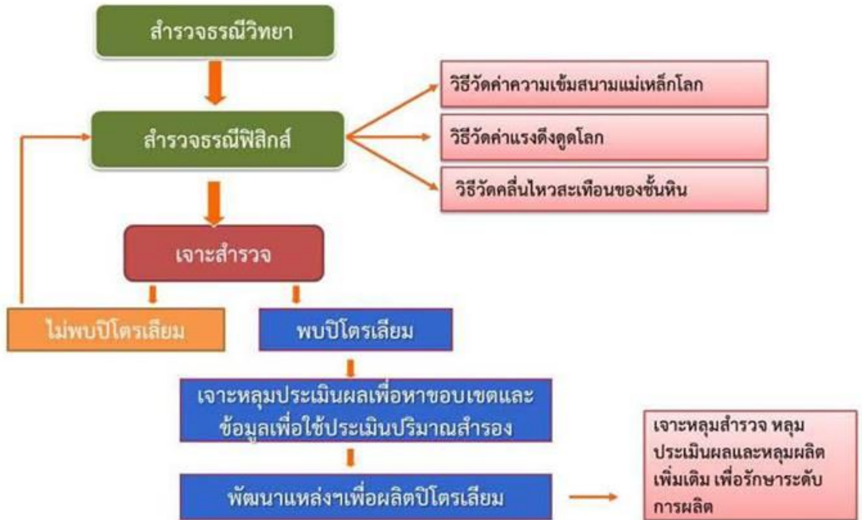
แผนภูมิแสดงขั้นตอนการสำรวจและพัฒนาแหล่งปิโตรเลียม
